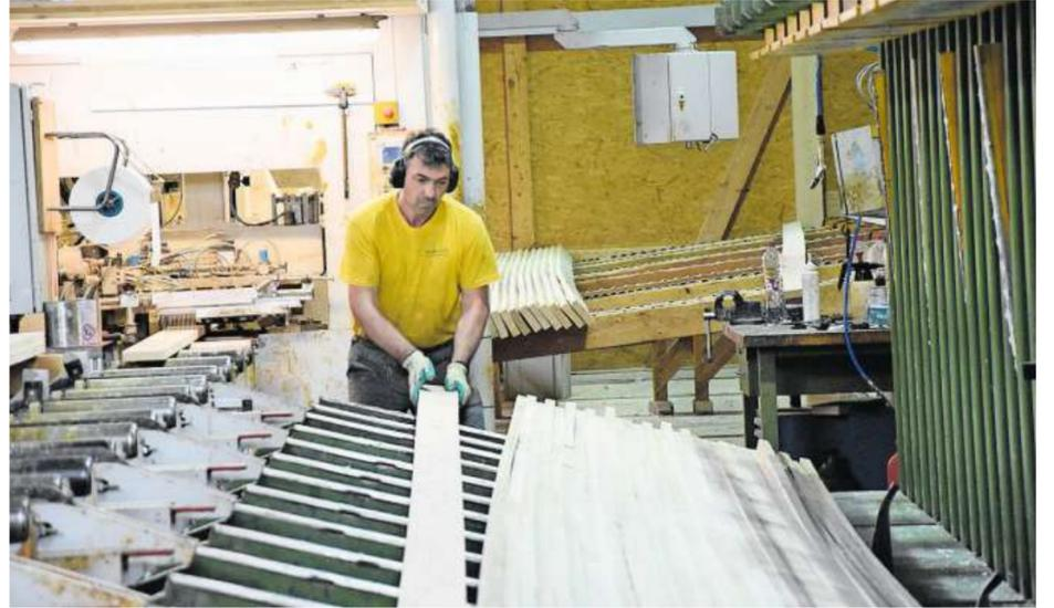
Nach dem Leimauftrag schichtet der Mitarbeiter die Holzlamellen für die Flächenverleimung in die Presse.
