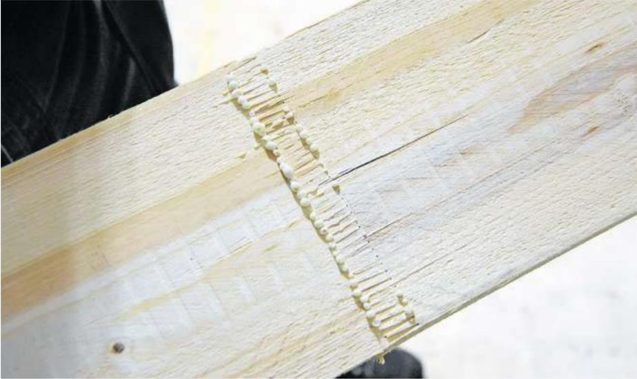
Die Holzlamellen werden in der Keilzinkanlage auf das benötigte Mass längsverbunden.
