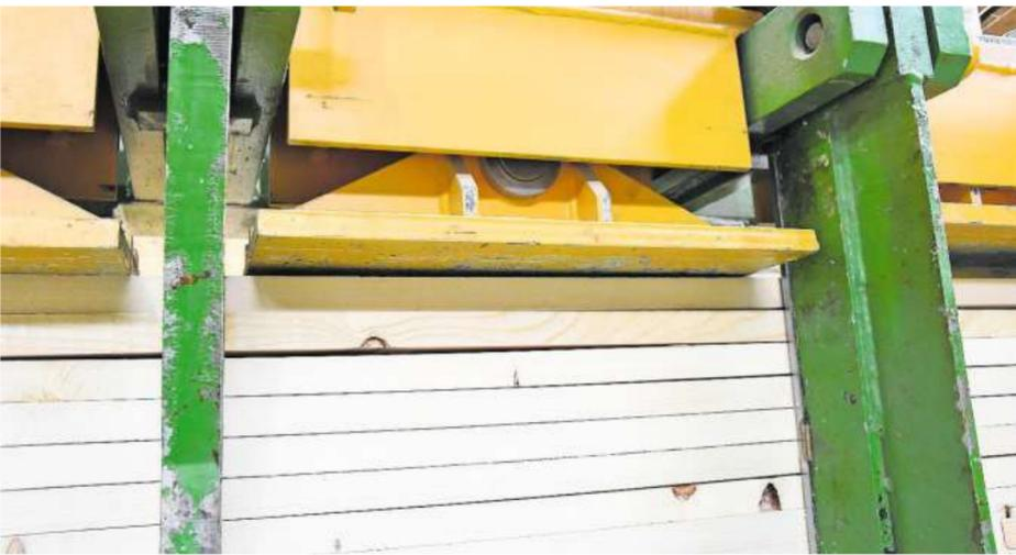
Know-how im modernen Holzbau: Während 30 Minuten erfolgt bei einem kontinuierlichen Pressdruck die Flächenverleimung. Bilder: Urs M. Hemm...
