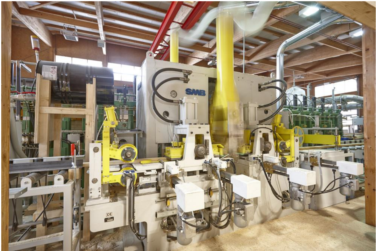
Die topmoderne Fertigungslinie zur Herstellung von Brettschichtholz und anderen Leimholzprodukten - hier die Keilzinkanlage (Bild: Necker Holz AG)
